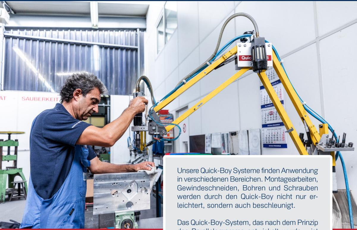
Unsere Quick-Boy Systeme finden Anwendung in verschiedenen Bereichen. Montagearbeiten, Gewindeschneiden, Bohren und Schrauben werden durch den Quick-Boy nicht nur erleichtert, sondern auch beschleunigt.
